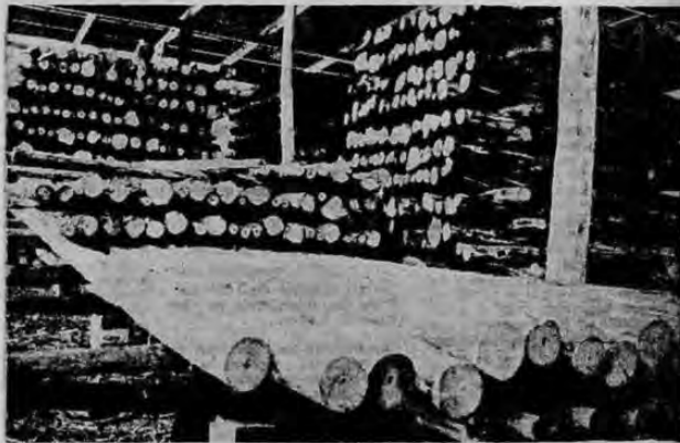
La madera debe ser secada completamente para asegurar absorción y retención del químico.
